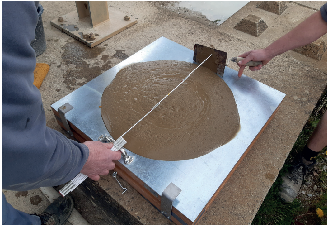
Abbildung 1: Ausbreitmaßprüfung fließfähiger ZFSV: nach dem Anmischen sofort verarbeitbar
