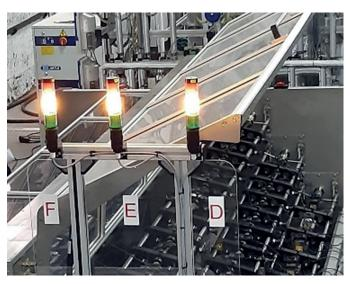
Wir freuen uns, Ihnen mitzuteilen, dass nach der Inbetriebnahme unseres neuen WZP-Prüfstands nun die ersten Messgeräte dem Stresstest auf Langzeitmessbeständigkeit und -messrichtigkeit unterzogen werden. Dieser neue Prüfstand ist gegenüber dem bestehenden Prüfstand für größere Wärmezähler in der Lage, die zu untersuchende Messgeräte direkt vor, zwischen und nach dem Stressprogramm zu prüfen.
