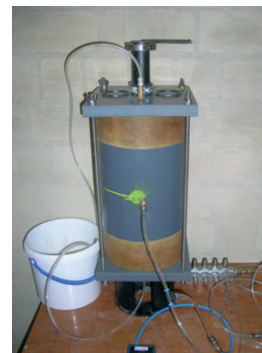
Abbildung 2: Re-SIST-Versuchsbehälter und idealisierte KWAI zur allgemeinen Beschreibung des Kontaktverhaltens zwischen ZFSV und KMR - Erstbelastung (Quelle: OTH.R)
